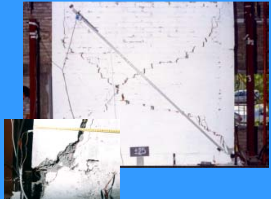
Falla por Corte en muros
